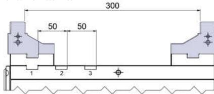
Spannbereich / Spannhub (mm)
