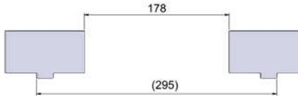
Spannbacken mit einstellbarer Prägertiefe & variabler Spannweite
