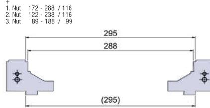
Spannbereich / Spannhub (mm)
