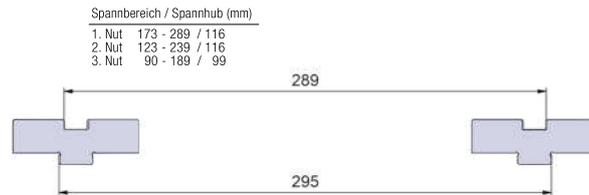
Bei Adapterbacke 89.088.80.02 besteht ferner die Möglichkeit, den Spannbereich zu erweitern bzw. zu verringern.
