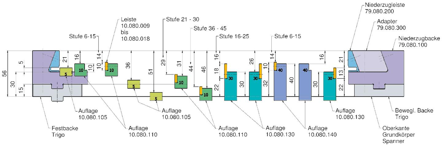
Durch Kombination der verschiedenen Auflagen mit den unterschiedlichen Leisten lässt sich nahezu eine lückenlose Stufenhöhe von 6 bis 56 mm erreichen.
