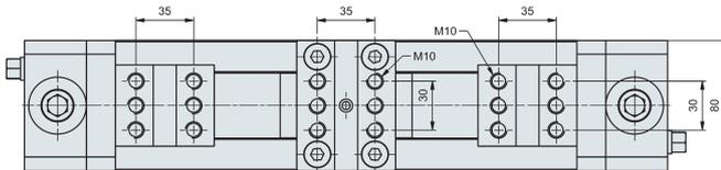
Spannbereich mit Wende- und Mittenbacke sowie Stufenwende- und Stufenmittelbacke
